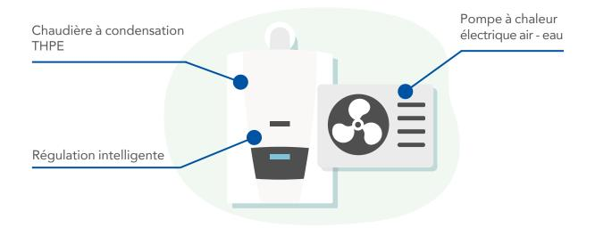
La PAC hybride gaz réunit le meilleur de deux technologies : un module chaudière gaz à très haute performance énergétique (THPE) et un module pompe à chaleur électrique de puissance raisonnée. Le tout est piloté par un système de régulation intelligent.
